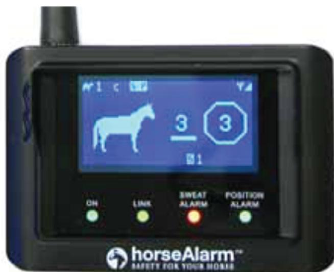
Если уровень потоотделения достигает до выбранного значения (или выше), ресивер начнет подавать звуковой сигнал, а также загорится индикатор отслеживания уровня потоотделения. Для выключения сигнала, уберите руку с сенсоров и нажмите кнопку С.
