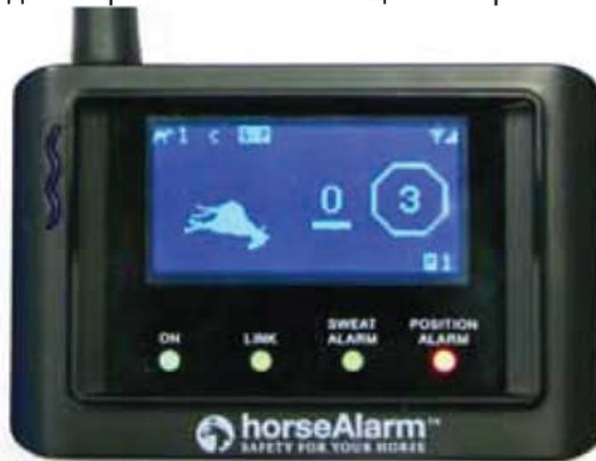
**Чтобы выключить оповещение, переверните передатчик в горизонтальное положение (надписью вверх) и нажмите кнопку С.**
